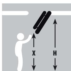
Les escaliers escamotables LMF60 jusqu'à une hauteur de 360 cm sont équipés en standard d'un mécanisme d'allègement, de sorte qu'ils peuvent être entièrement actionnés avec une manivelle.
